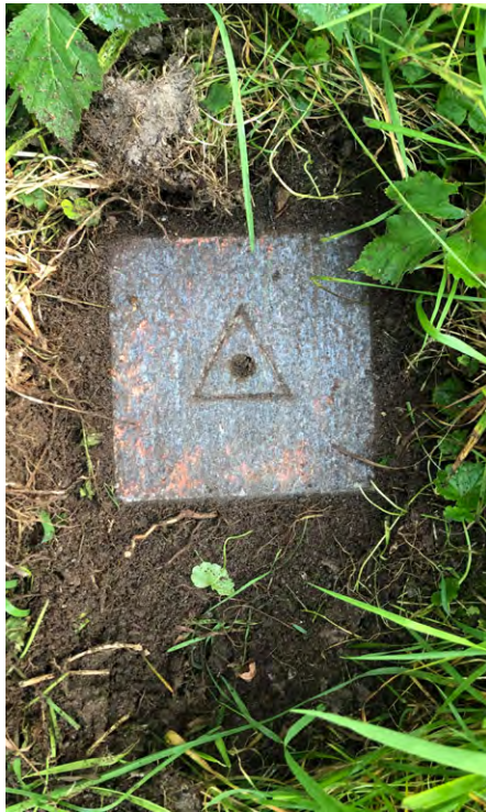
Abb. 2: Granitstein eines ehemaligen Triangulationspunktes mit eingemeisseltem Kreuz (heute LFP3).
