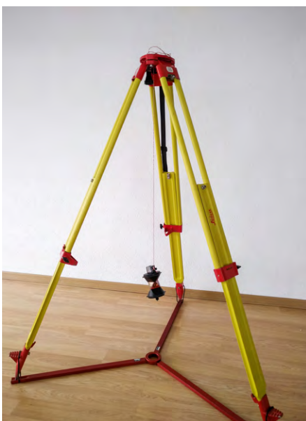
Abb. 3: Versuchsvorrichtung mit einem pendelnd aufgehängten Prisma.
