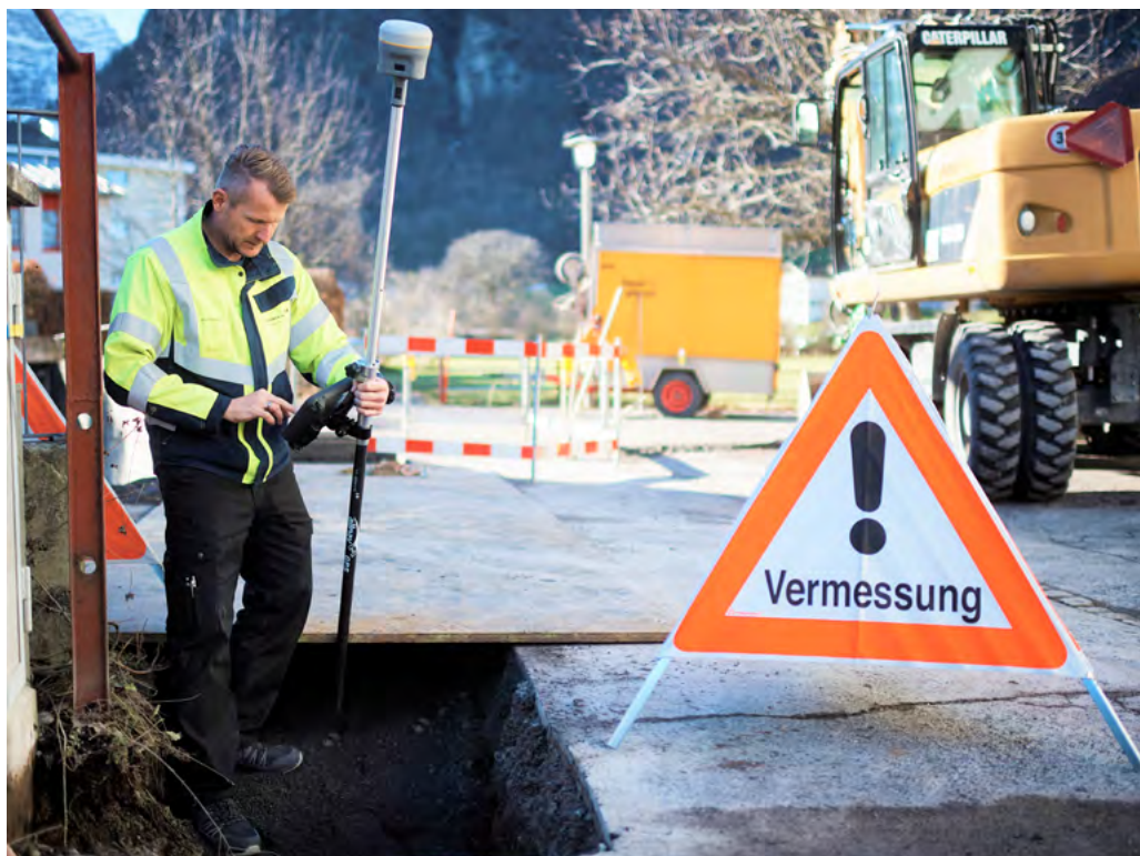
Trimble R12i mit hochgenauer Neigungskompensation mittels IMU für ein direktes, unkompliziertes und schnelles Messen – auch von überdeckten und bis anhin mit einem GNSS nicht messbaren Punkten (Foto: Technische Betriebe Glarus).
